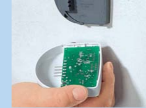
Die Abdeckung samt Platine auf das Gehäuse stecken. Die Thermostate regeln die ...
