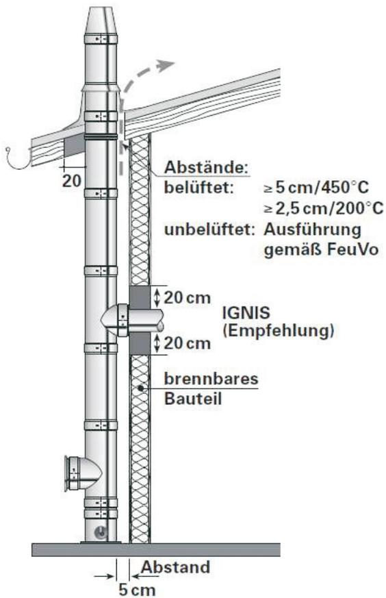
Beachten Sie bei der Montage von ISO-BIT dass der belüftete Mindestabstand, bei einer max. Abgastemperatur von 450°C, zu brennbaren Bauteilen 5,0 cm beträgt.
